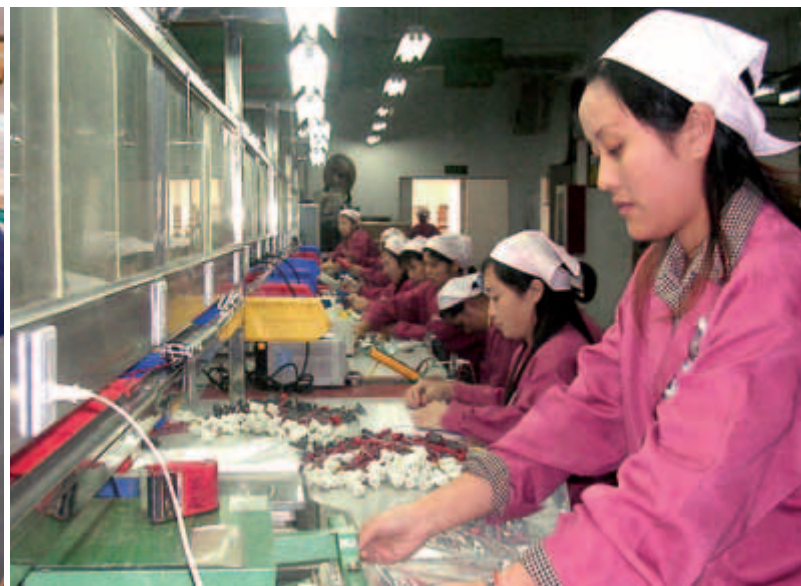
Montagearbeiterinnen in Kunshan bei der Produktionin von Kabelbäumen für die Automobilindustrie.
